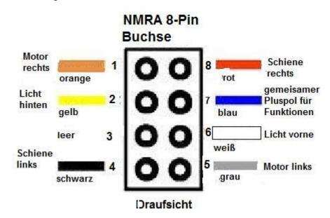
Bedrahtung des Decoders/Belegung des Steckers:
